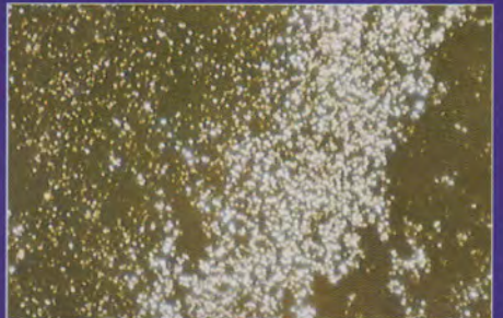
Mikroskopaufnahmen aus dem Kühlrohr der Kältekompressoren bei einer 200-fachen Vergösserung: die Abbildung oben (Referenz) zeigt schöne Aragonitnadeln, die Abbildung unten (unter Feldeinfluss entstandene Ablagerung) zeigt keine erkennbaren kristallinen Strukturen, die an Oberflächen haften können.
