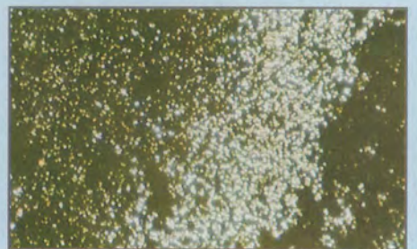
Mikroskopaufnahmen aus dem Kühlrohr der Kältekompressoren bei einer 200-fachen Vergässerung: die Abbildung oben (Referenz) zeigt schöne Aragonitnadeln, die Abbildung unten (unter Feldeinfluss entstandene Ablagerung) zeigt keine erkennbaren kristallinen Strukturen, die an Oberflächen haften können.
