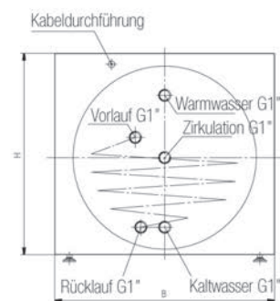
ANSCHLUSSSCHEMA ZU LSP 150 UND 200
